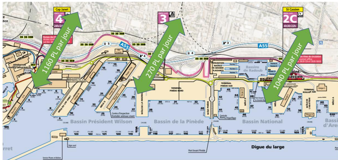
Figure 19 : Entrées / sorties quotidiennes PL sur le Port par les portes 2C, 3 et 4 (du Sud au Nord) – source enquêtes Alyce
