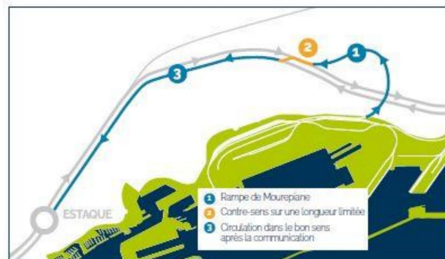
Figure 12 : Après 2030, zone de contresens réduite en sortie du raccordement, aiguillage permettant de reprendre la voie dans le bon sens
