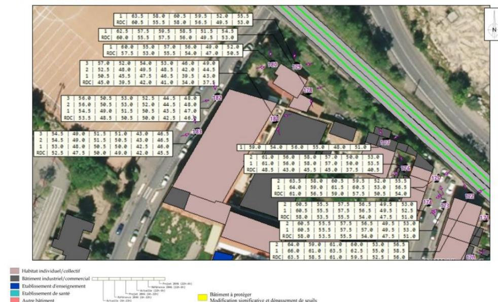
Figure 62 : Illustration des modélisations réalisées pour quantifier les effets cumulés acoustiques
