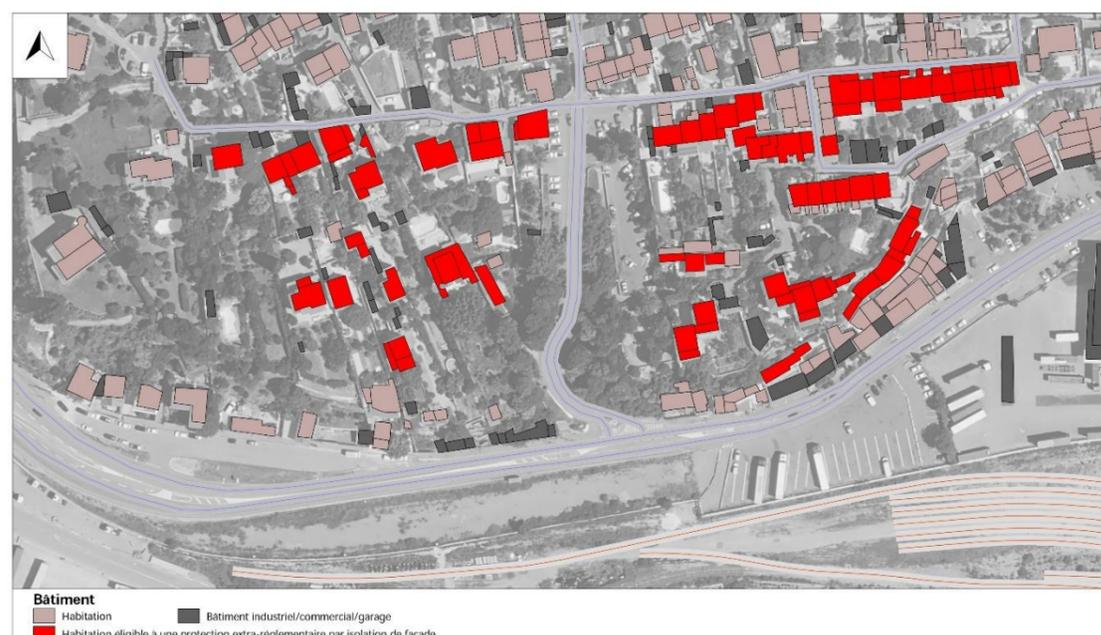
Figure 66 : Identification des bâtiments dépassant les seuils d'émergences admissibles : 5 dB(A)
